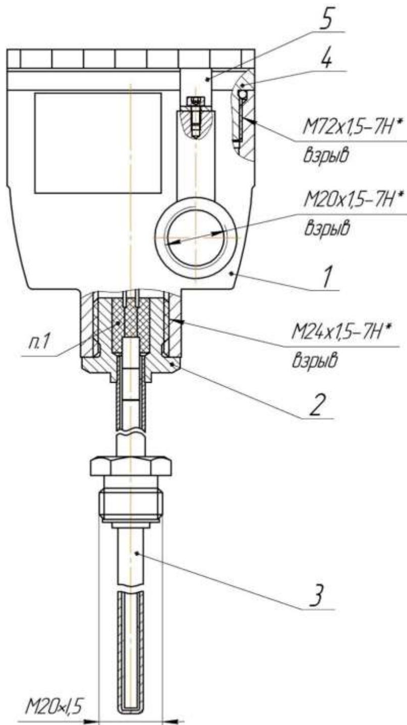
1 - корпус датчика; 2 - штуцер; 3 - термозонд;
