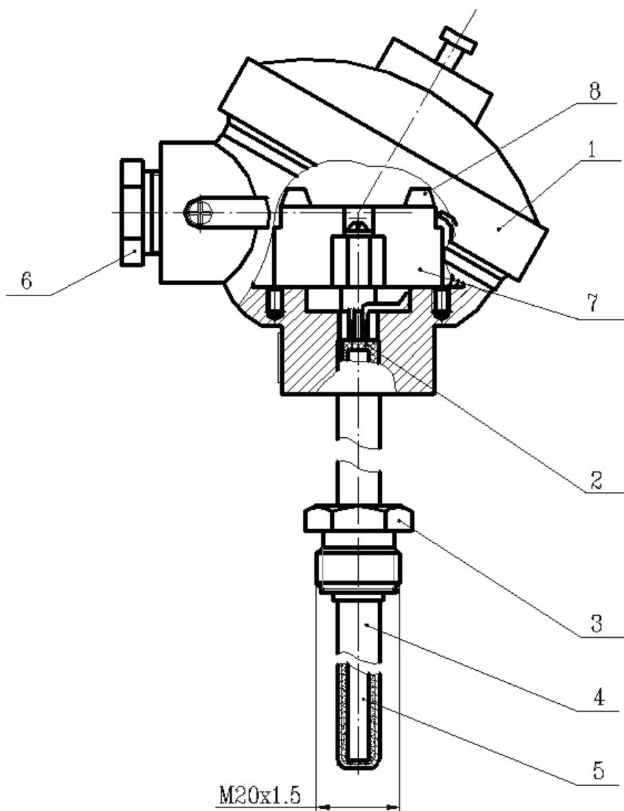
1 - корпус измерительного преобразователя; 2 – заливка компаундом; 3 - штуцер; 4 - термозонд; 5 - термочувствительный элемент; 6 - кабельный ввод (или разъем 2РТТ); 7 - измерительный преобразователь; 8 - колодка измерительного преобразователя
